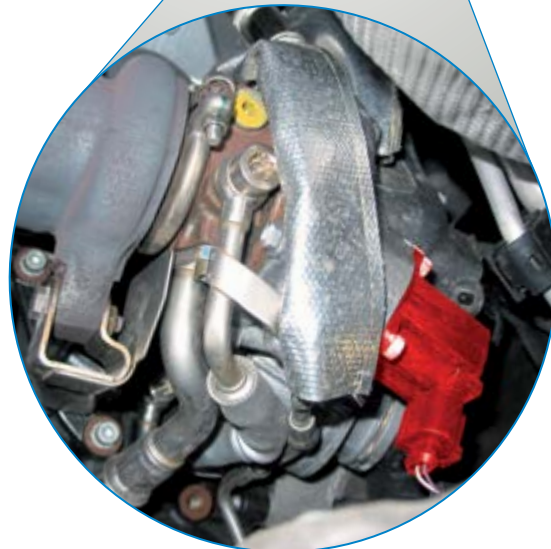
Schubumluftventil im VW EOS TFSI (rot hervorgehoben)
